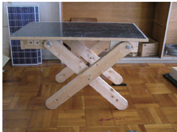
写真1 電子機械科製作の高さ可変卓球台
