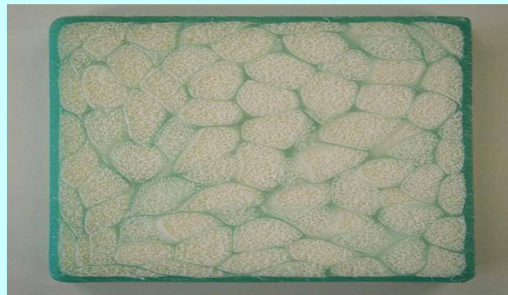
発泡体、補強体、表皮が接着した成形体の断面
