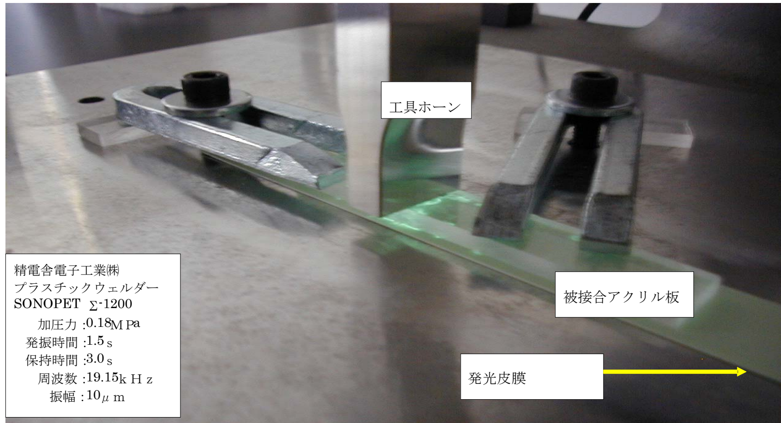
図6. プラスチックウェルダにおける超音波振動の発光による可視化
