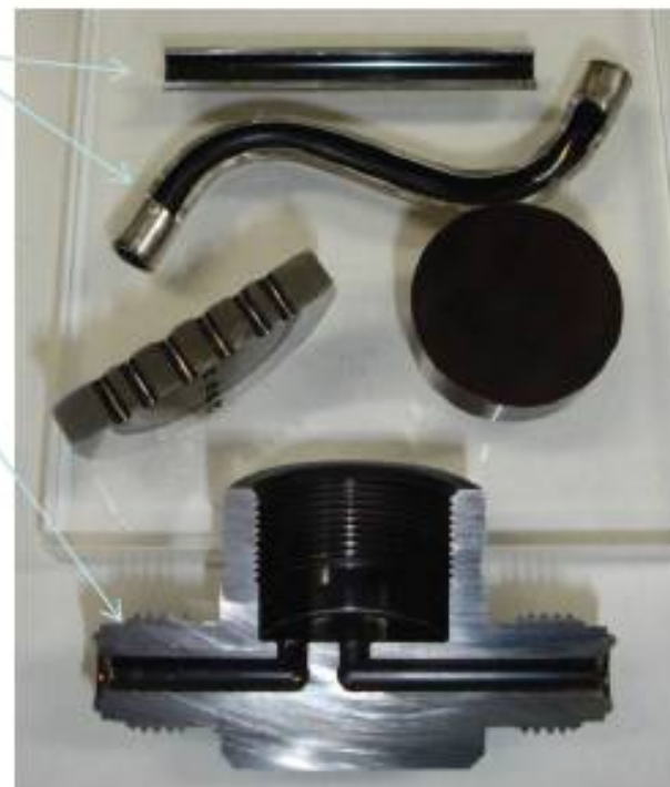
図4 各種部材内面へのDLC成膜(写真)。
