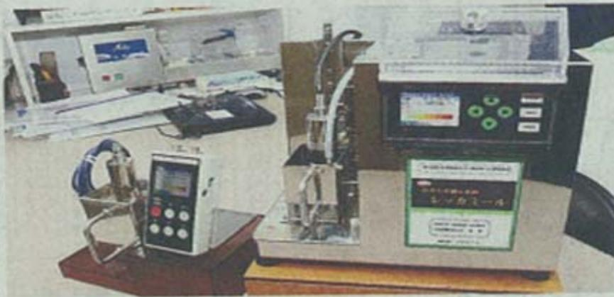
油関連機器開発のファミリーユ(広島市南区)は、揚げ物などに使う食用油の劣化度を測る装置を広島大学院と共同開発した。油の交換時期を的確に把握できる装置として、食品
