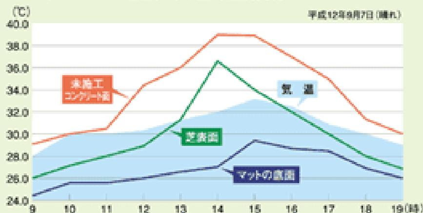
屋上コンクリート面は、かなり高温になり照強と放射を繰り返します。さらに緑化していない表面は直接紫外線や熱作用があるため、緑化している場合と比べ建物の劣化が早くなり寿命を縮めます。
