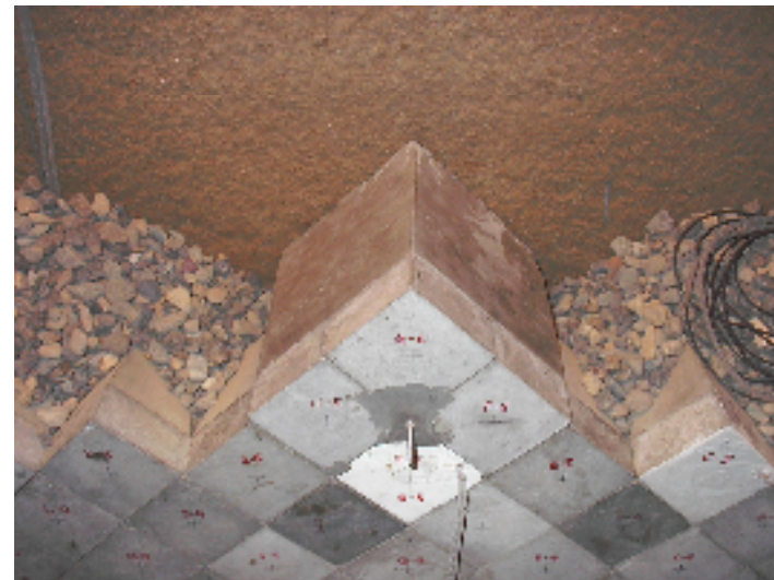
対策工の模型 (間知石と裏グリ石の部分固化)
