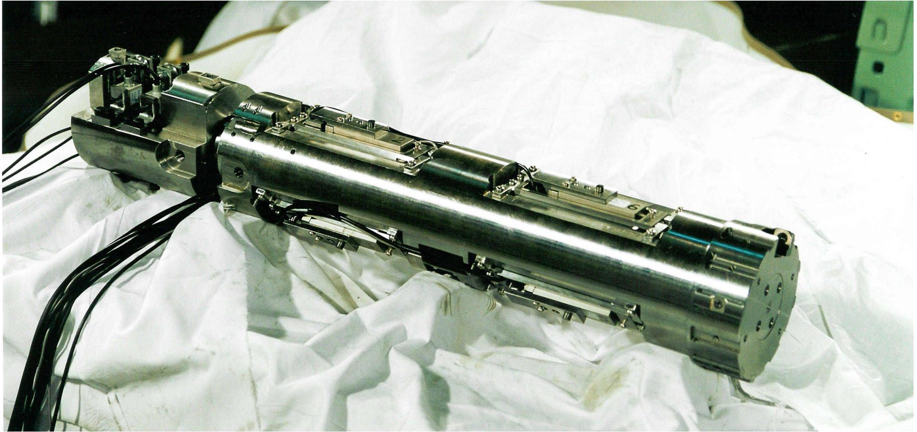
レーザー誘導方式深穴加工工具
