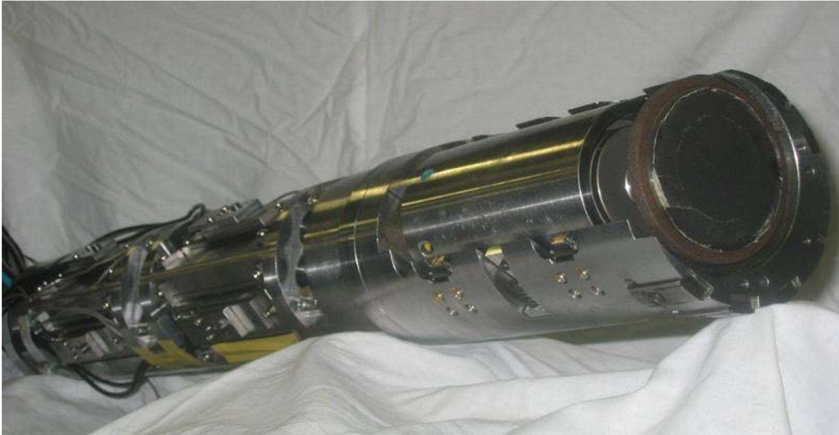
レーザー誘導方式深穴内面仕上げ加工工具
