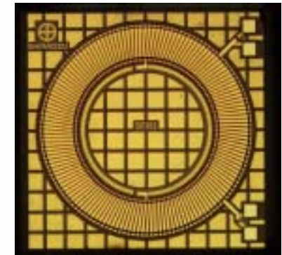
薄膜フラックスゲートチップ (2.6mm角、1軸タイプ)
