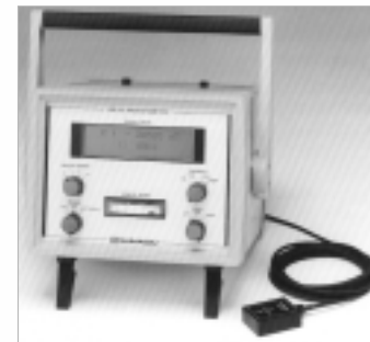
従来のフラックスゲート磁気センサ(バルク型)
