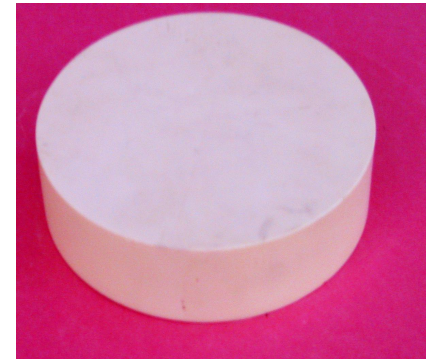
成形時200mm \phi \times 50mmの焼成体
