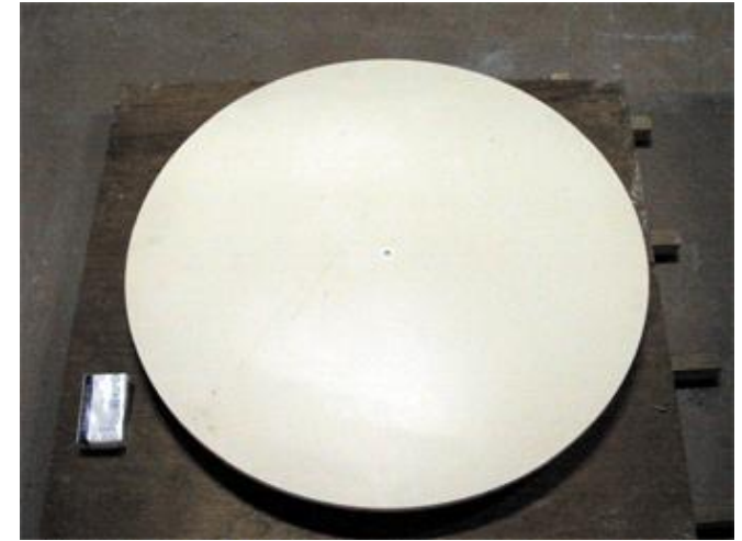
研削後の焼成体 650mm \phi \times 12.6mm
