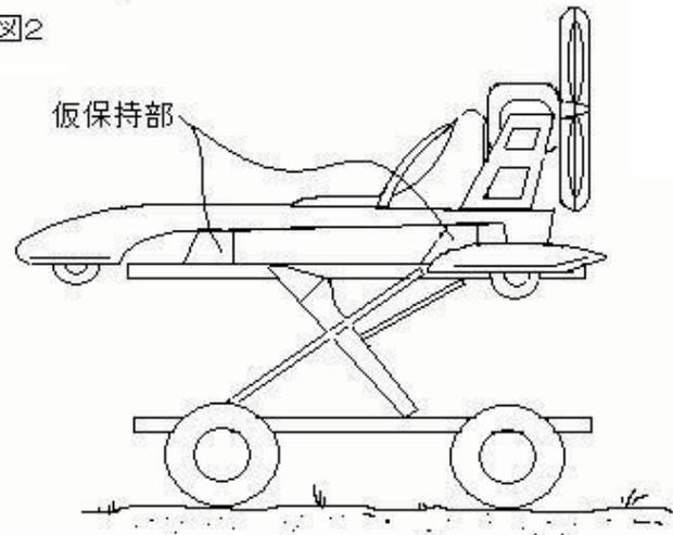
図2はパラプレーンを載置した状態を示す。載置するものに応じて、仮保持部の形状が異なる
