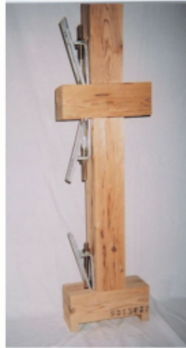
上下階連層耐力壁の例
