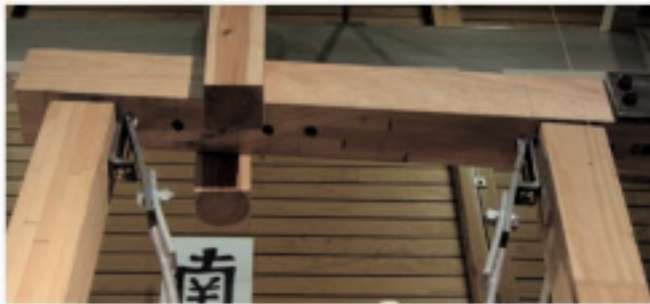
耐震補強金物の施工モデル図
