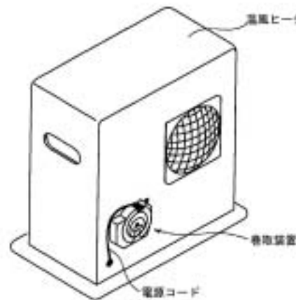
図3 温風ヒータの電源コードを収納した巻取装置
