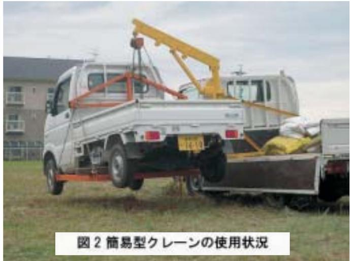
図2 簡易型クレーンの使用状況
