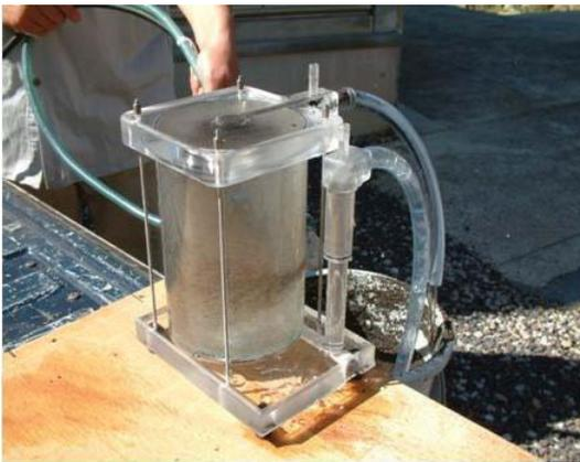
図2 油水分離機の試作模型
