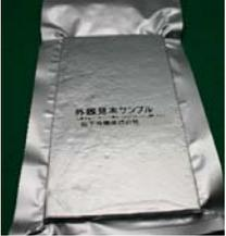
高性能真空断熱材の構成と外観見本サンプル
