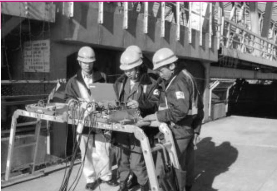
図1 橋に取り付けた複数のセンサーからの信号をケーブルで引き出し、現場で測定から診断まで行い、橋の余寿命を予測する
