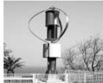
図1 ダリウス・サボニウス併用型風力発電機
