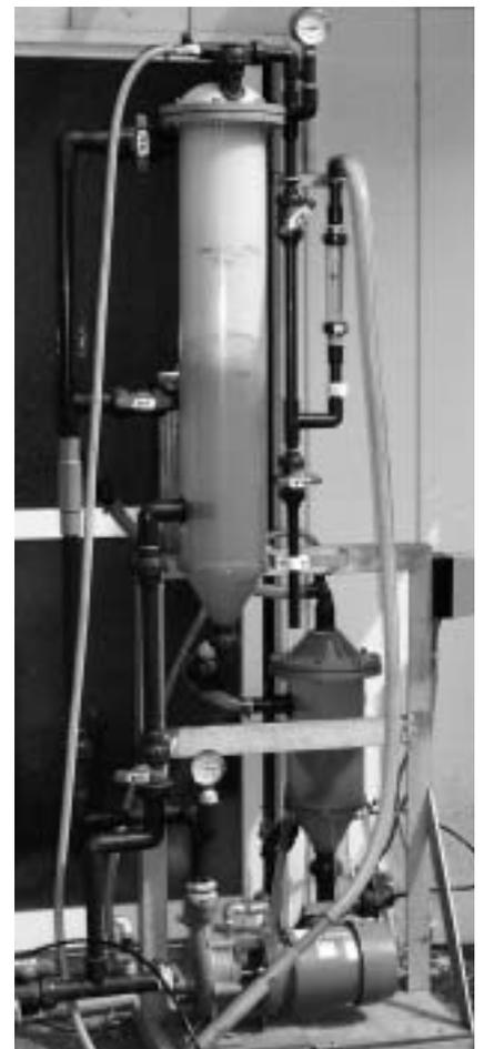
図1 最新試作機では、ろ材の分離用の2段目ろ過室が加わった
