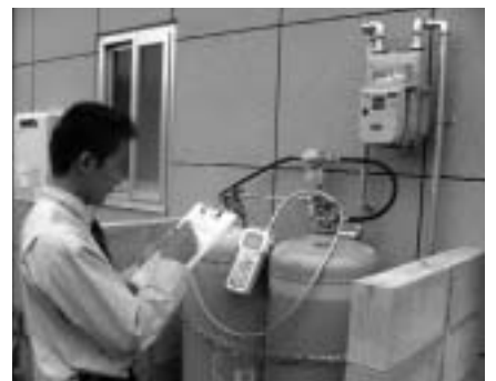
図2 「セーバープロ」を使ったプロパンガスのガス漏れ検査
