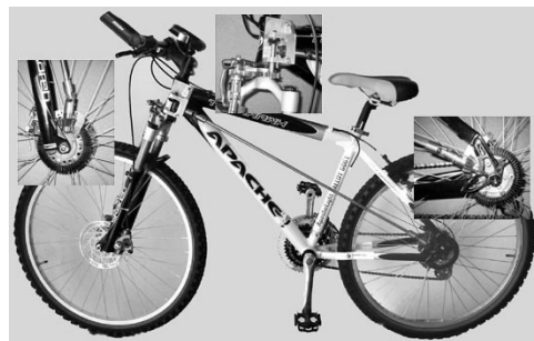
二輪駆動自転車 ハンドルの下(写真中央)に後輪からの動力を前輪へ伝えるギアが複雑にセットされている。
