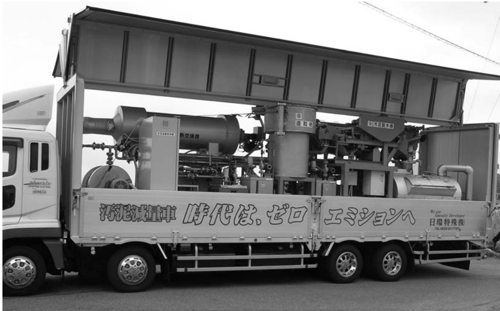
汚泥減容車「フェニックス」は、汚泥の減圧から炭化物化まで一連の処理をまとめた、同社自慢の移動式装置
