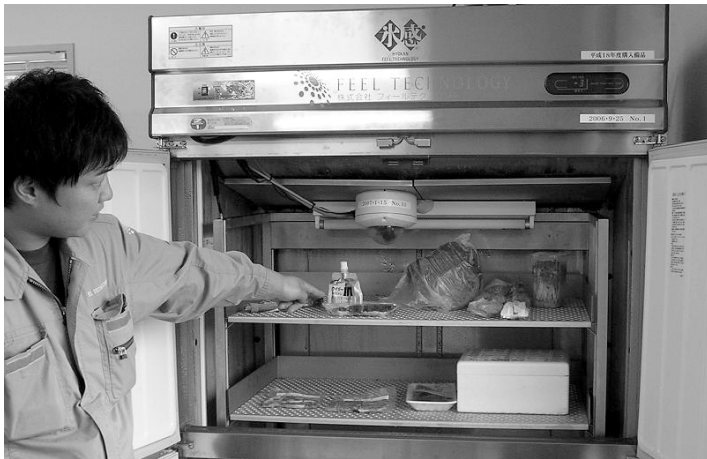
「氷感庫」の内部 静電場を発生することで氷点下の凍結を防ぐ
