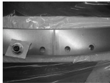
FSWによる気密リングの接合部位
