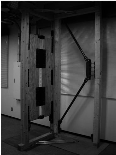
右が設置された「K-ブレース」。左側は同時に開発された粘弾性ダンパーを合板に設置したものの。
