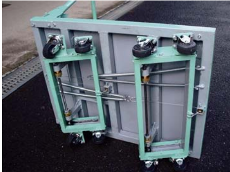
「段差楽々スロープ内蔵台車」 台車で重量物を運ぶ際に段差が越せない場合がある。これを解消するために車輪部分にスロープをつけた 第64回全日本学生児童発明くふう展 「恩賜記念賞」受賞
