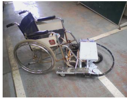
車椅子補助装置「すすむ君」 特別支援学校からの依頼で製作した車椅子電動化装置。運動会の徒競走で、車椅子の生徒がボタン操作でゴールを目指す 第66回全日本学生児童発明くふう展 「発明協会会長賞」受賞
