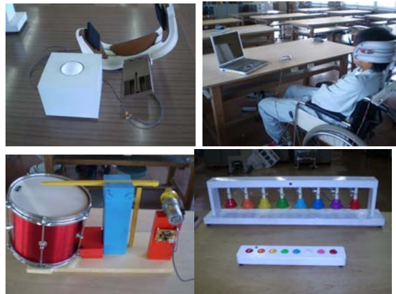
「頭でクリックしマウス&ボールマウス」 手の不自由な特別支援学校の生徒がデジタル絵本のページめくりを頭でクリックできる装置 香川の発明くふう展 県教育長賞受賞 「楽器演奏機（太鼓&ハンドベル）」 特別支援学校の音楽の授業で使ってもらう装置
