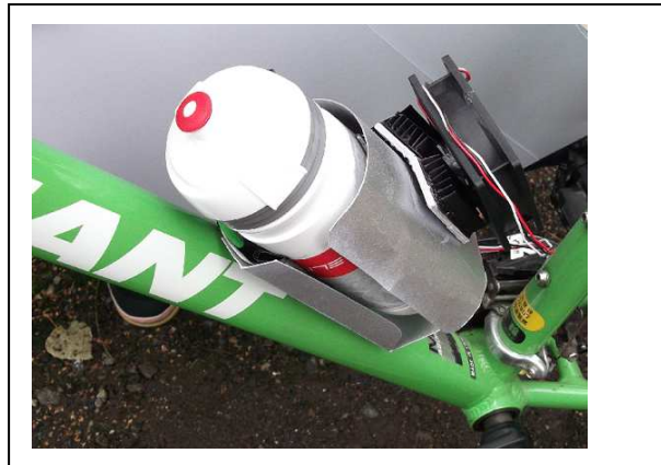
創作作品「ペットボトルとペルチェ素子を利用した自転車サドル冷却器」
