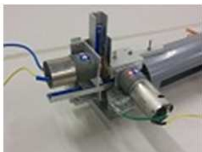
ロケットランチャーの発射装置 右のモーターで青いラックを引く
