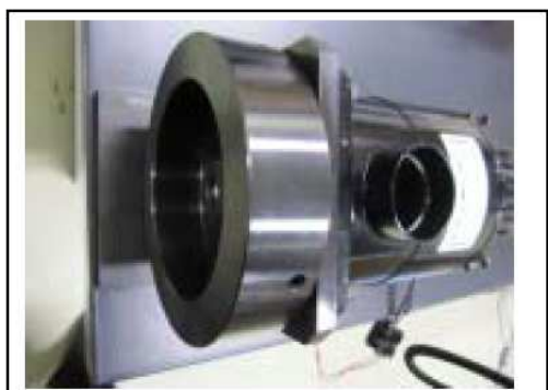
写真3. フライホイールによるエネルギー回生
