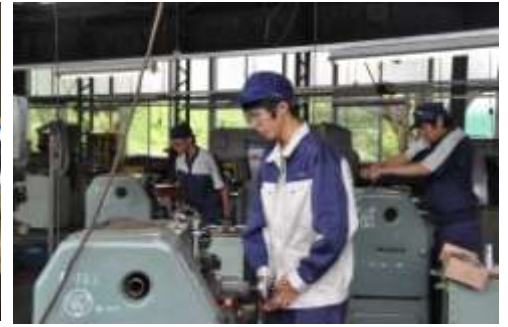
写真5 部品加工(旋盤)
