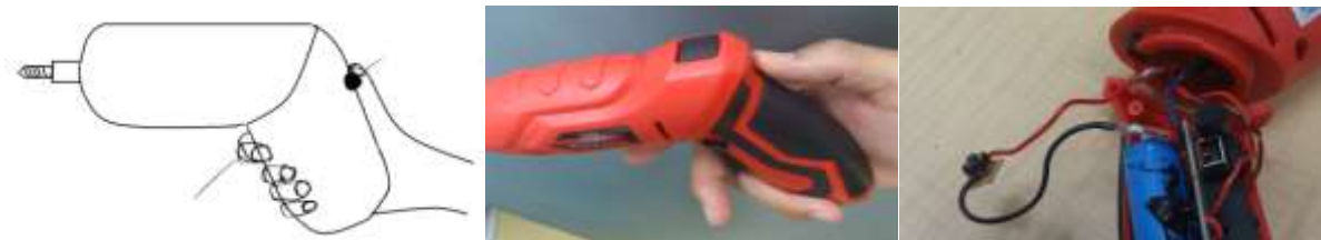
図1. 作品例 1:電動ドリルの安全装置
