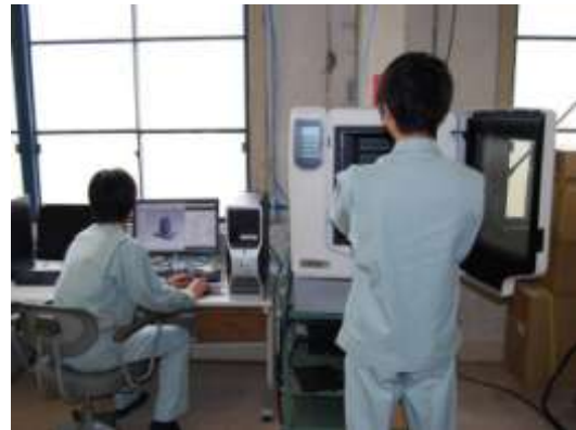
写真2. 設計援用システム(3D-CAD)と試作システム(3D-Printer)
