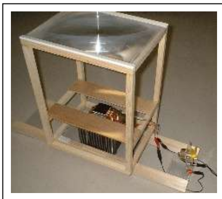
写真3. 太陽熱温度差発電
