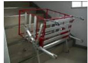
写真12 階段でも車輪が転がり、荷物を運搬できる器具
