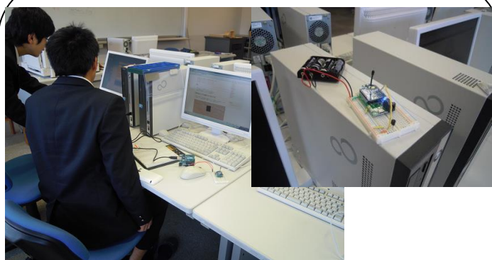
図5. マイコン(Arduino)とxbeeを使用した温度測定
