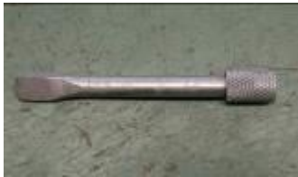
写真5 溶接用ノズル内側のスパッタを除去する器具を考案試作
