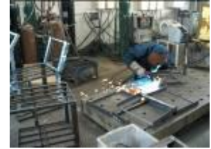
写真8 ボールを入れるボックスを運搬するカートの修理、改善と試作
