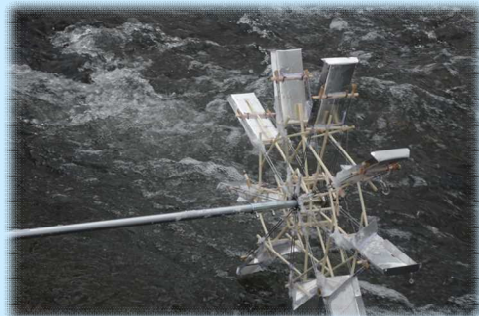
写真5 エネルギーの地産「凍結防止用水車」
