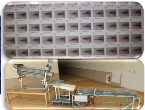
(写真3) ハタハタ雌雄選別装置製作
