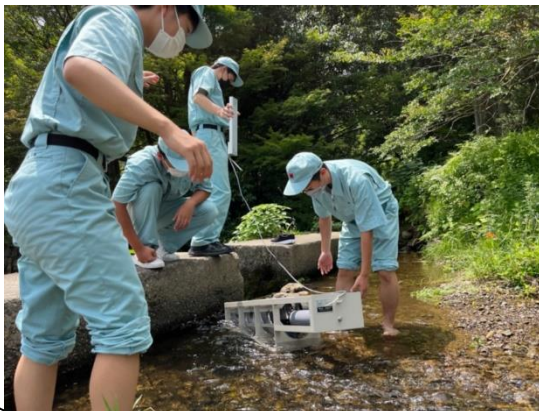
(写真3) 試作品1号の水車の実証実験
