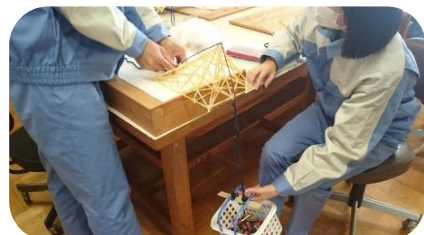
写真1 パスタクレーン計測風景
