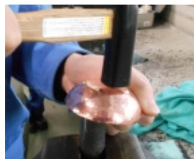
写真⑥ 鍛金による銅器制作 2 (槌目仕上げ)
