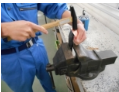
写真⑤ 鍛金による銅器制作 1 (打ち絞り)
