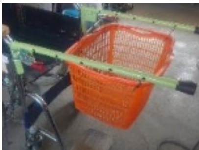
図4 車いす用買い物かご補助アーム ～ 試作品 ver ～
