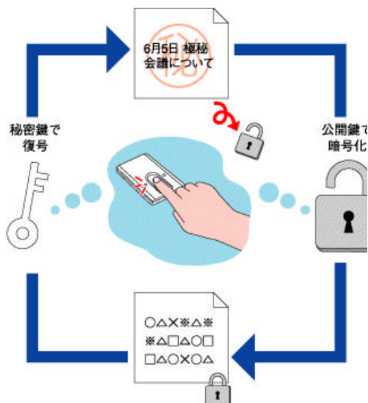
図 2.4.2-4 ソニーの指紋認証に使われている暗号化のしくみ
