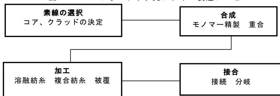
図 1.1.2-1 プラスチック光ファイバ製造プロセス
