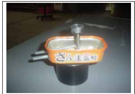
写真4 製作した空き缶ポンポン船
