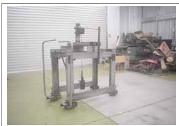
写真5 改良した重量物運搬装置
