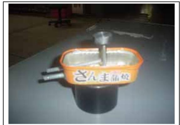
写真4 製作した空き缶ポンポン船
