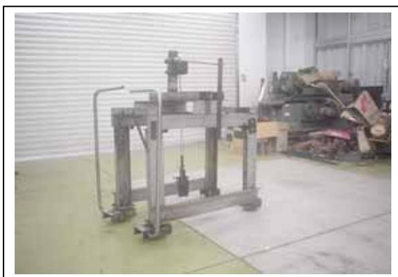
写真5 改良した重量物運搬装置
