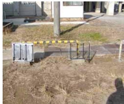
写真8. 太陽熱温水器の温度変化測定
