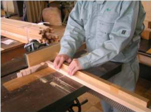
写真3. 丸のご盤による切り出し加工
