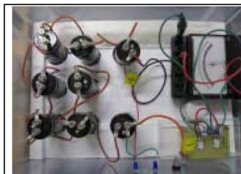
写真4. 電気二重層キャパシタ蓄電システム
