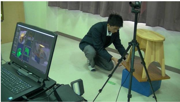
図 1 スツールの 3D スキャン
