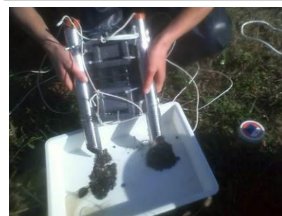
(写真5) 完成した採泥器
