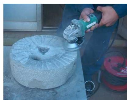
写真10 近隣の農家から未使用の石臼を譲り受けて、小麦製粉用石臼に改造している様子。
