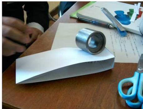
写真6 紙でスロープをつくり、車イスが走行することを想定して鋼の円筒を転がして、強度や摩擦など考察。
