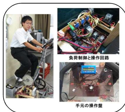
(写真3) エアロバイク発電装置
