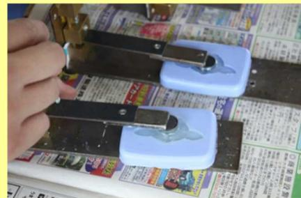
(写真) 手作業の樹脂成型 (真向き兎)
