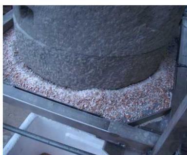
写真11 改造した石臼で、小麦を破碎、粉碎している様子。石に彫る溝の形状によって、製粉の状態を考察する。
