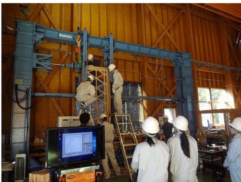
(写真7) 県林業試験センターとの共同研究(鹿沼組子耐力壁強度実験)
