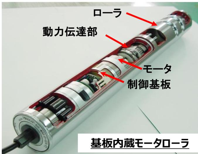
主要製品である「パワーモータ」は、ローラパイプにモータ・ギヤ・動力伝達部を内蔵し、ローラ自身が回転し品物を搬送するモータ内蔵ローラです。
