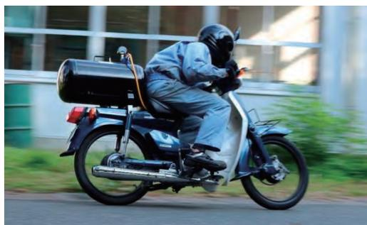
一般に市販されているガソリンエンジンを改造し、燃料を使用せずに圧縮空気で動力を発生する空気エンジンを搭載した自動二輪(以下、空気バイク)を製作。
