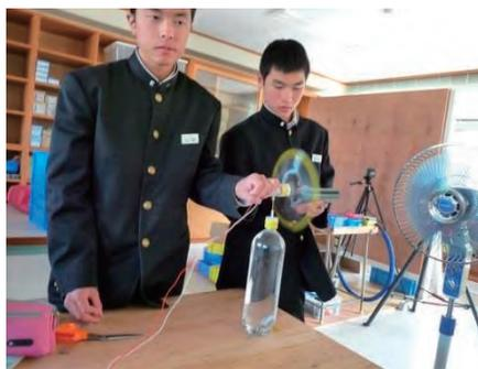
(写真2) 風車の回転数測定
