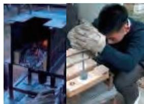
写真5 焼き印の温度を上げるための専用の保温炉の開発
