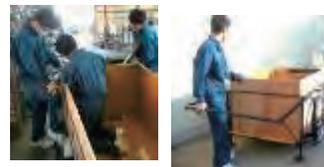
写真12 製作した防災用カー（骨組みの周りに木材を取り付け）
