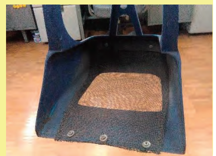
図 6 製作した石拾い機
