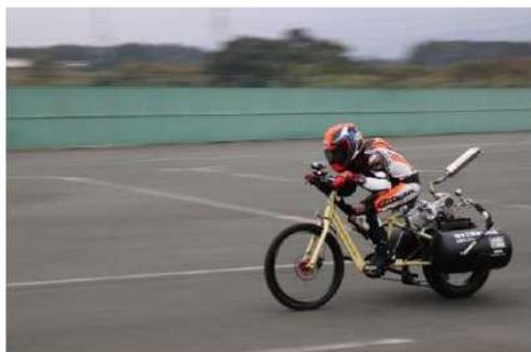
一般に市販されているガソリンエンジンを改造し、燃料を使用せずに圧縮空気で動力を発生する空気エンジンを搭載した自転車(以下、空気自転車)を製作。
