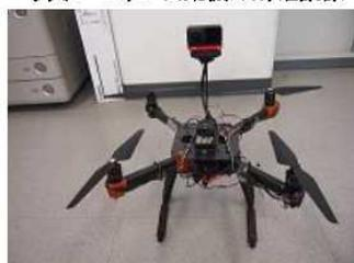
写真3 360度カメラ搭載ドローン
