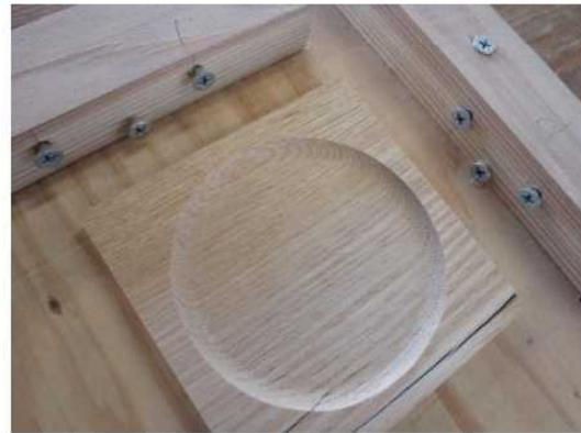
(写真4) 写真3 拡大 加工位置をビスで調整
