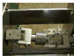
写真13 地域連携として手打ち製麺所のうどん圧延機（自在鶏手の自作）
